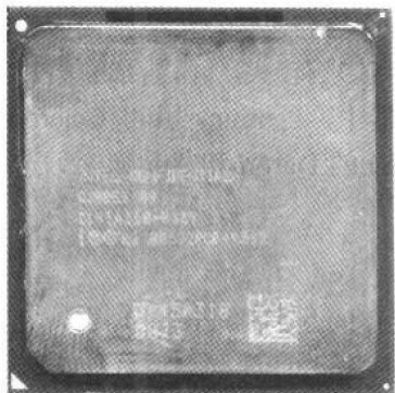
图 1.4 Socket 478 插座 Pentium 4 处理器
