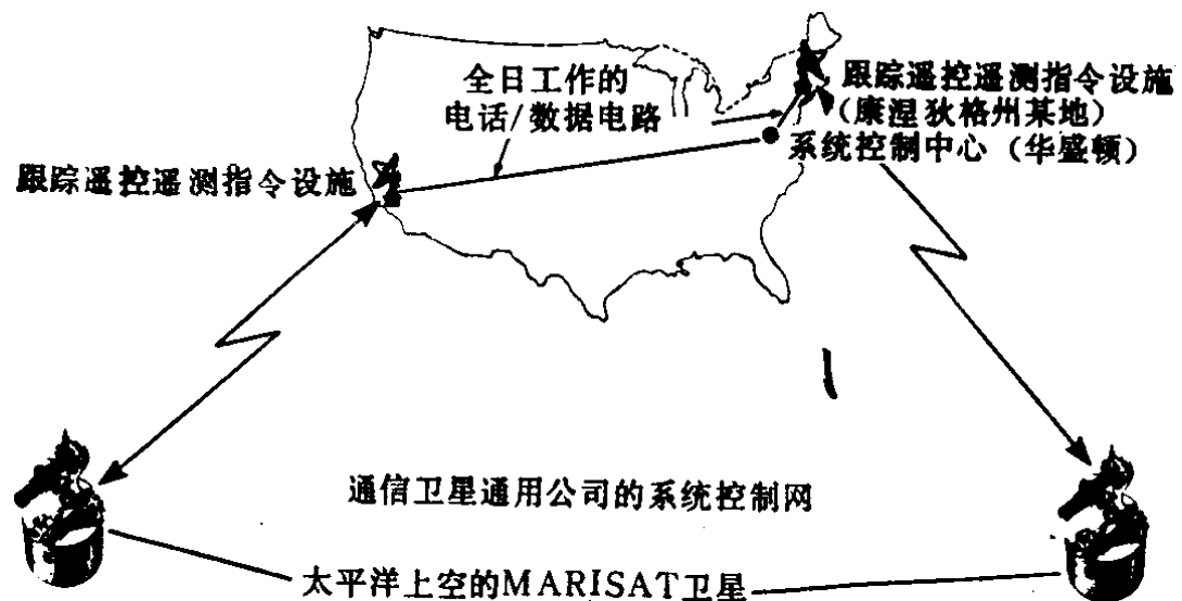
图 17.1 Marisat 卫星系统能够把世界各地的船舶接入企业通信网，进行电话和数据通信，现在的船舶可以配备同陆上办公室一样的通信设施（图中的跟踪遥控遥测指令设施系安装在加利福尼亚州某地）
