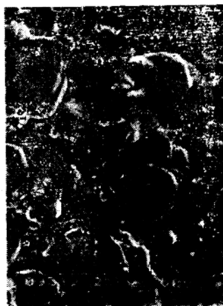
图2-4 电火花加工表面
