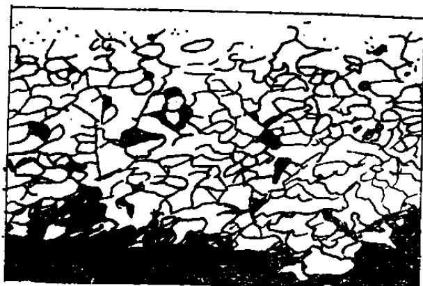
图 1—2 硬合金淬火人工时效材料的晶间腐蚀
