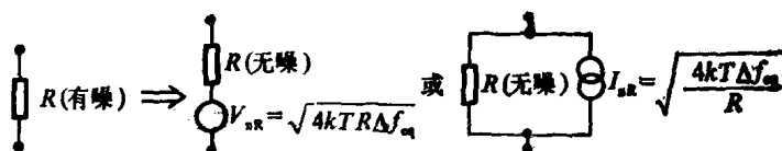
图 1 电阻噪声模型等效电路
