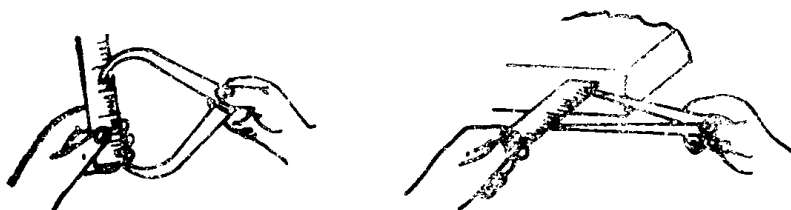
图 2—9 在钢板尺上测量尺寸
