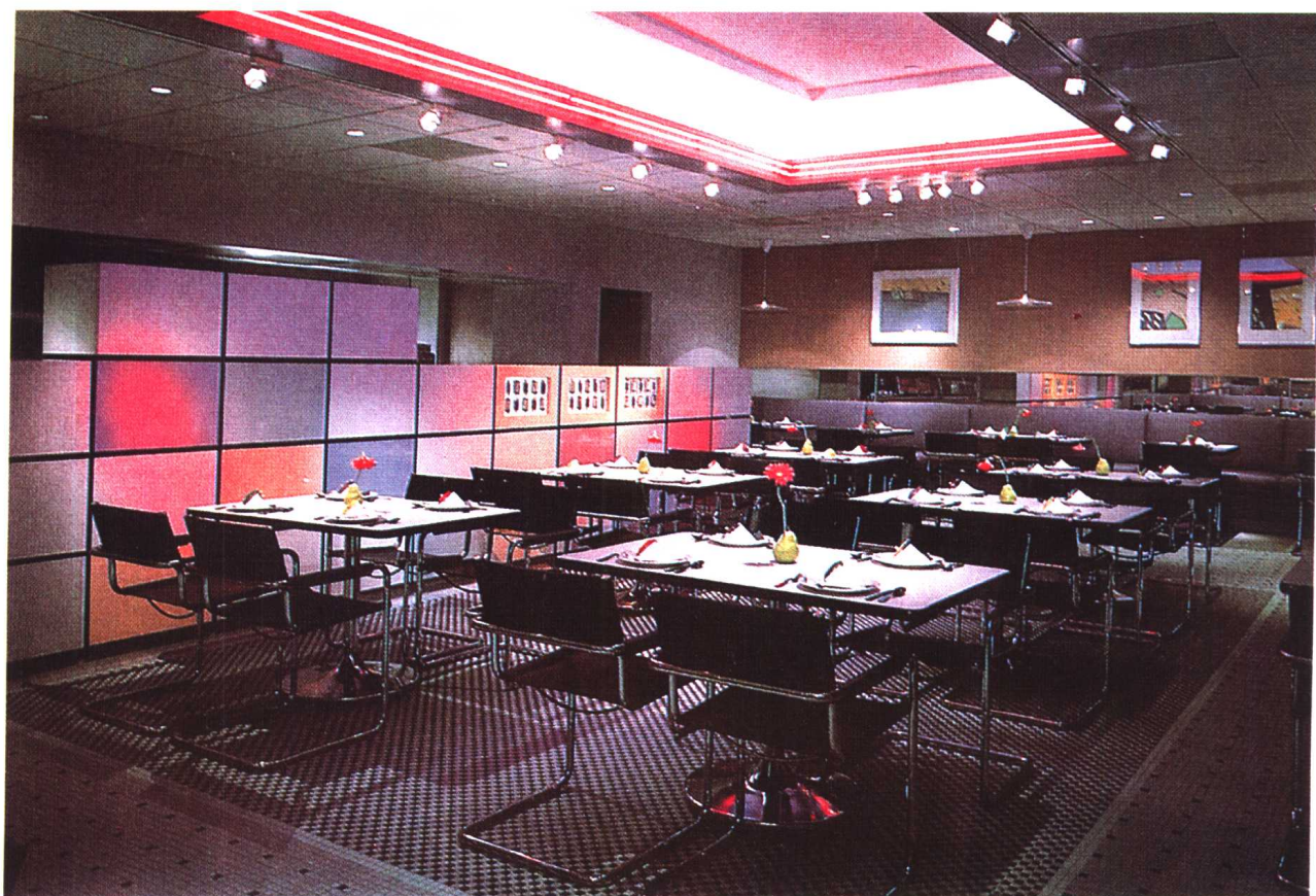
公司餐厅照明，采用荧光灯与射灯相结合，气氛非常融合
