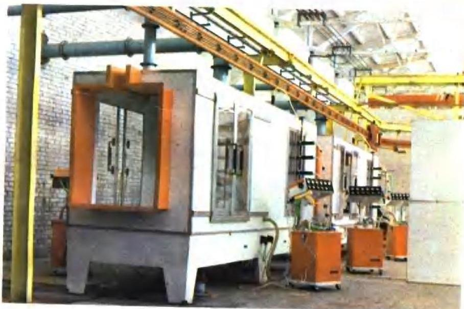
**HTQ**系列粉末涂料摩擦静电喷枪是我厂于84年在分析国外同类产品后研制成功的新型涂料工具，目前广泛应用于成套喷涂设备和大型流水线喷涂设备。
