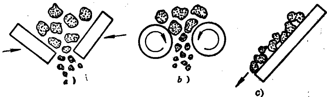
图1-4 磨粒磨损的三种类型
