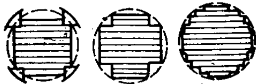
图1—4 铁芯截面 (a)正方形铁芯； (b)十字形或两级铁芯； (c)多级铁芯片
