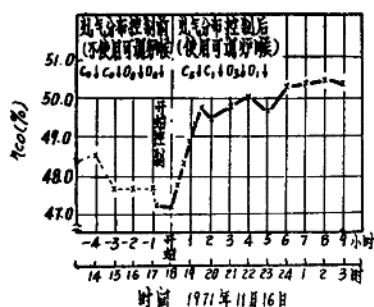
图15 开始采用可调炉喉进行煤气分布控制前后的气体利用率的变化
