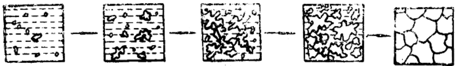
图2-5 金属结晶过程示意图
