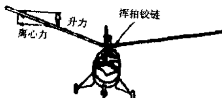
图2 在叶片的根部安一个 水平的挥拍铰链
