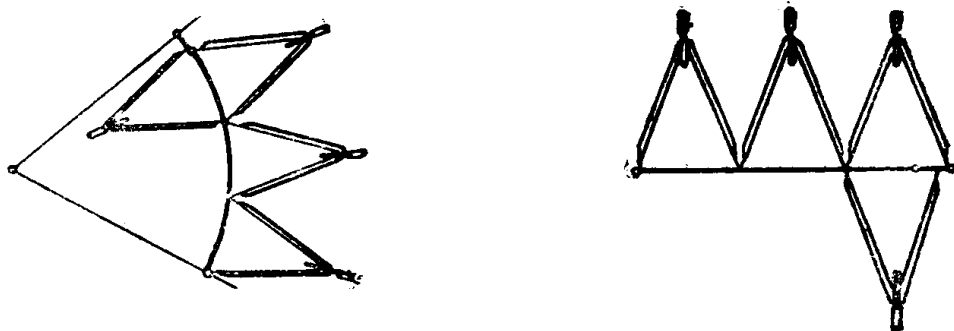
图 1—8 用分规等分线段和圆弧
