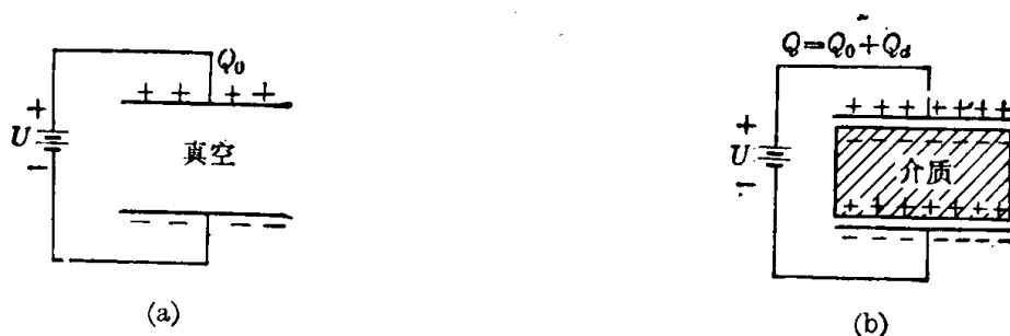
图 1-6 介质极化使电容器极片上的电荷量增大
