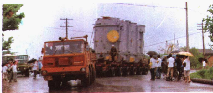
▲ 500千伏无锡斗山变电所50万千瓦安主变压器在运输途中
