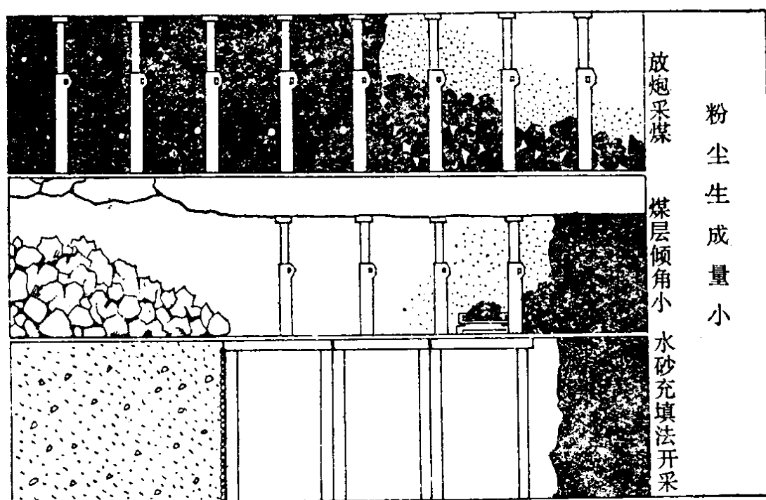
打眼放炮采煤、煤层倾角小、水砂充填法开采，粉尘生成量小。
