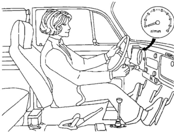
发动机无法启动时，首先应通过马达声或转速表的指示情况，弄清点火开关拧到启动挡后，启动机是否开始转动及转动是否有力。
