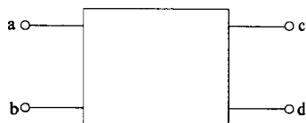
图 1.1 用黑盒表示的电子电路
