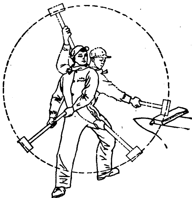
图1-14 抡打中锤头在各个位置时打锤工的姿势
