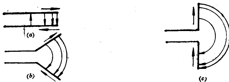
图1-8 由平行双线到对称振子
