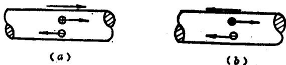
图 1-2 电流的正方向
