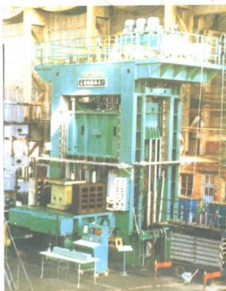
为 1000t 液压机配套的液压总成
