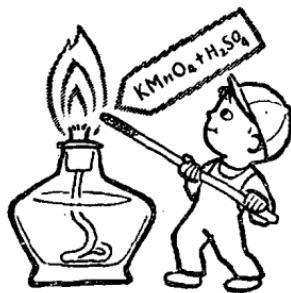
**答案** 因为浓硫酸和高锰酸钾都是强氧化剂，当浓硫酸和高锰酸钾一接触到酒精灯芯上的酒精后，立即放出大量的热，并达到了酒精的着火点，于是酒精灯就很快点着了。实验后，应把上述剩余的混和物倒入废液缸里，并用水把烧杯、玻璃棒洗净。
