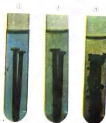
图1-1-8 铁钉在硫酸铜溶液里的反应
