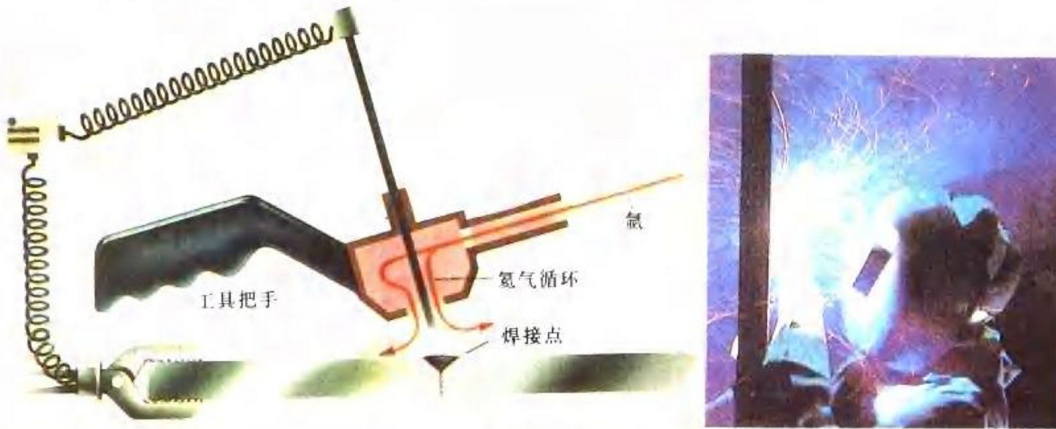
图1-2-2 焊接时，用氦、氩气做保护气
