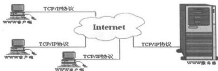
图 1-1 WWW 网络传输模型
