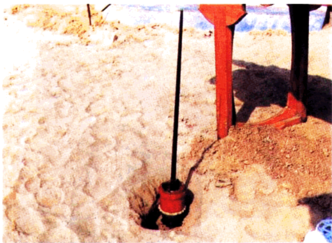
带触发杆的炸坦克车底地雷
