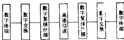
图 1-7 数字通信网系统原理结构模型
