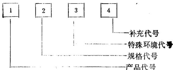
2. 电机产品代号：电机产品代号由电机类型代号、电机特点代号、设计序号和励磁方式代号四个小节顺序组成。
