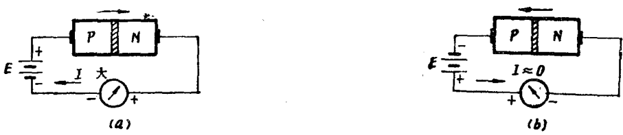
图1-7 PN结连接方式 (a) 正向连接, (b) 反向连接。
