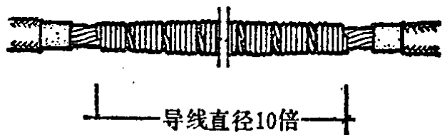
图1-9 多芯导线单卷直线连接
