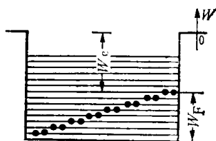
图2.1-14 金属中自由电子的逸出功
