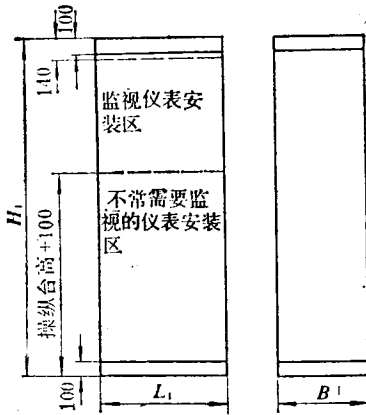
图44.2-18 仪表盘（柜、框架、屏）与独立操纵台配合布置时，盘、台上的仪表安装区
