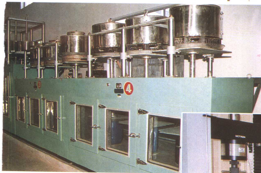
常州进出口危险货物包装检验所 自行设计制造的塑料罐、塑料桶高温 堆码测试设备
