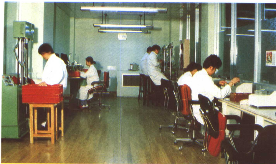
无锡进出口生丝检验 所恒温实验室（生丝强伸 力、抱合、捻度、纤度检测）
