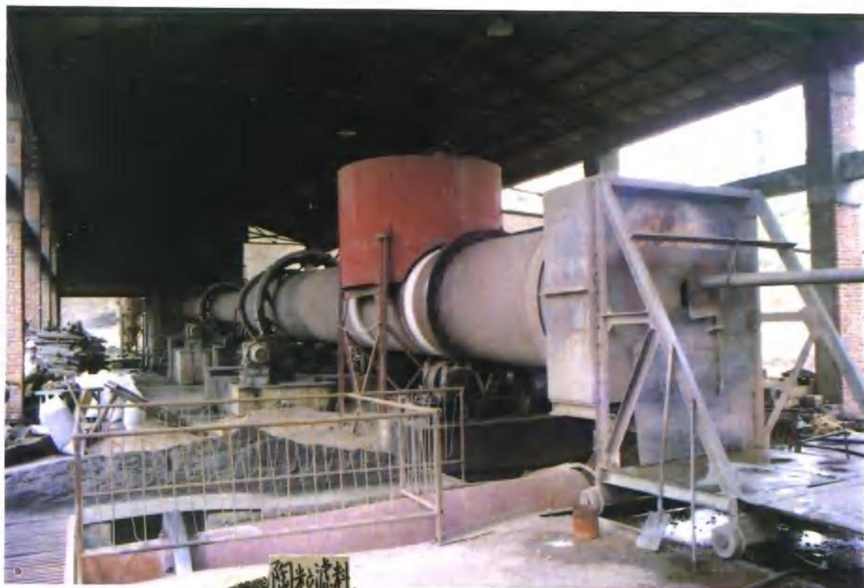
可保煤矿陶粒厂焙烧车间回转窑
