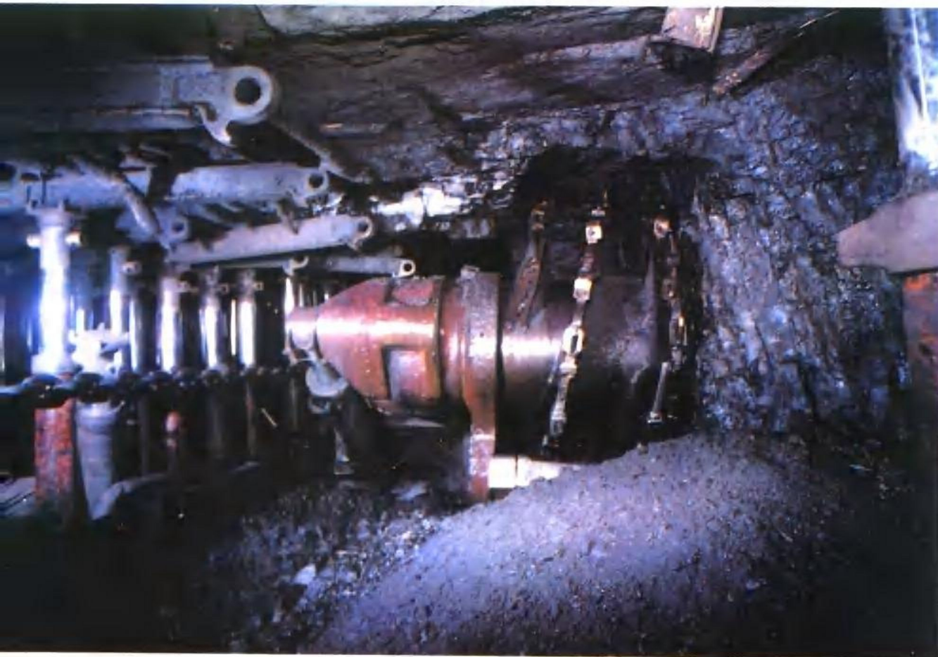
后所煤矿机械化采煤工作面
