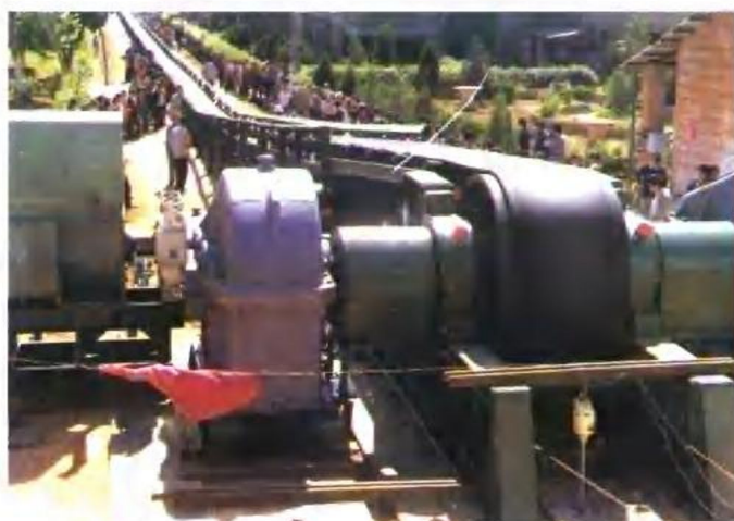
昆明煤矿机械总厂生产的 DX 钢绳芯带式 输送机
