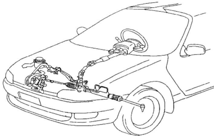
汽车行驶时，驾驶员可转动方向盘来改变或修正行驶方向，并通过它的振动感知路面状况。现代汽车一般都以前轮为转向轮，方向盘通过转向器等装置使其偏转。
