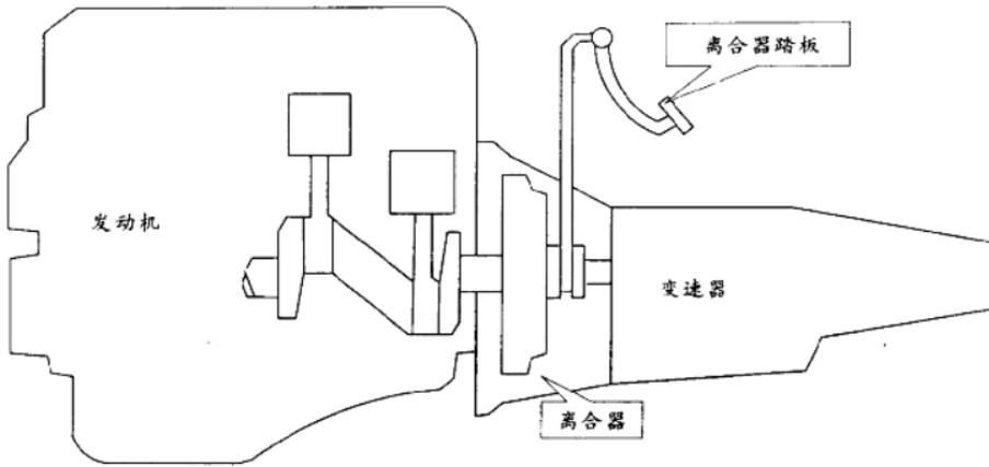
为保证换挡时不打坏变速器齿轮，在发动机与变速器之间装有离合器。踩下离合器踏板，可切断动力的传递。
