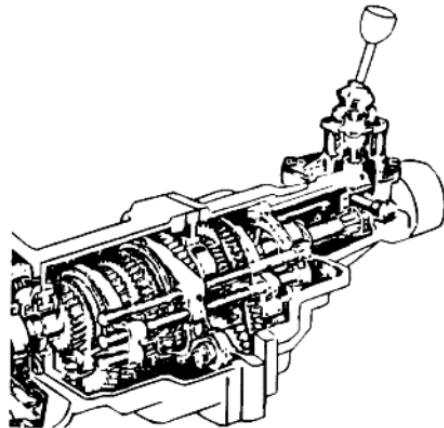
变速器内有若干组齿轮，通过操纵变速杆，可改变这些齿轮之间的传动关系，使汽车在好路上能以较高的速度行驶，在坏路上能产生足够的动力。轿车一般有4~5前进挡，挡位越高，车速越快，力量越小。另外还有一个倒挡和一个空挡，倒挡用于使车辆向后退着走，空挡用于停车而又不使发动机熄火等场合。
