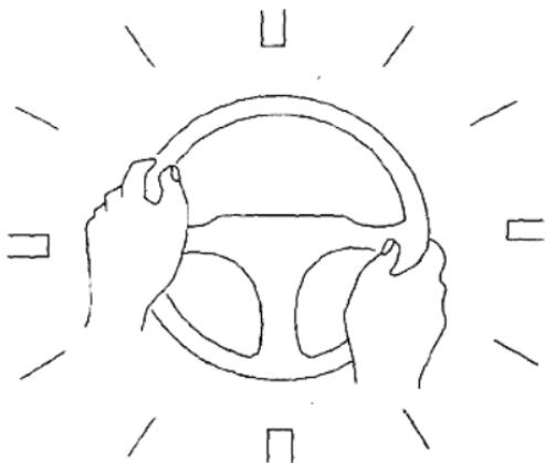
手握方向盘时，可按时钟刻度来定位，左手握在9~10时之间，右手握在3~4时之间，拇指向上自然伸直，四指由外向里握住盘缘。转动方向盘时，应两手配合，一手推送，一手拉接。当转动幅度过大时，可两手交替动作，轮流回位。汽车停稳后，不要原地转动方向盘，以免损坏机件。
