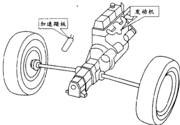
汽车由发动机、底盘、车身、电气设备四个部分组成。发动机是动力源，多安装在汽车前部，通过底盘的离合器、变速器、主减速器、万向传动装置、半轴等驱动车轮。驾驶员通过踩加速踏板来控制发动机的工作，向下踩得越多，发出功率越大，车速越高。
