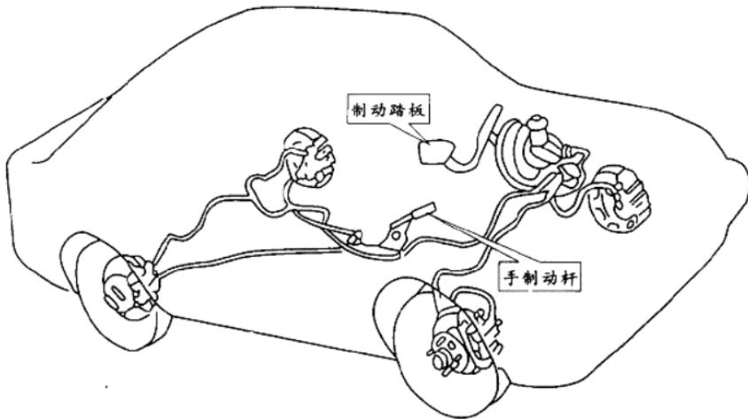
为使汽车减速或停车，驾驶员需使用制动装置，它包括行车制动系和驻车制动系。行车制动系由制动踏板控制，踩下踏板时可通过车轮制动器将全部车轮抱死，产生制动力作用。驻车制动系由手制动杆控制，拉起后能避免车辆自动滑溜，停车时应先用脚刹将车停稳然后拉上手刹。
