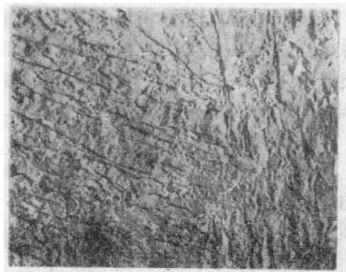
图 1-6 40Cr1250°C加热、1200°C锻造、 75%形变、840°C保温1小时淬水 10000×
