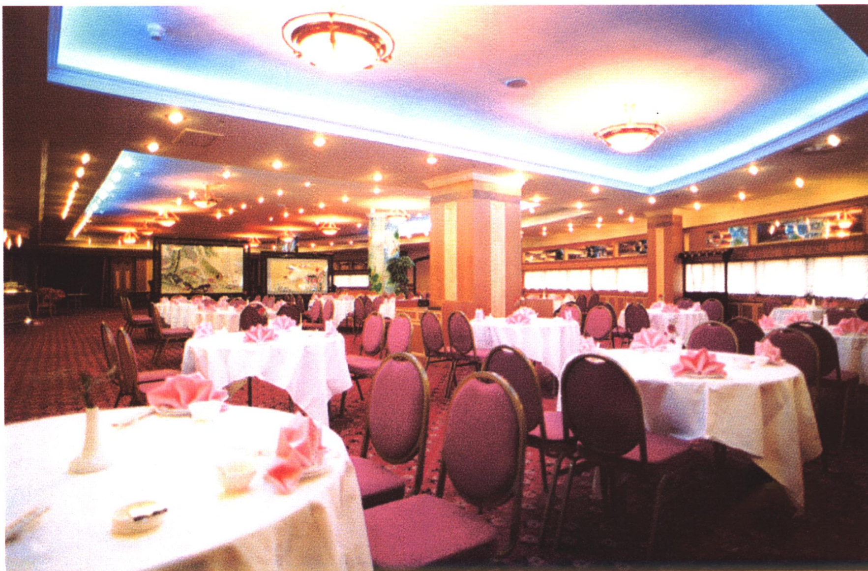
设备管道从下沉的顶棚位置穿通，同时将大面积顶棚上凸，使层高较低的大餐厅取得了较好的空间感 彩图 24
