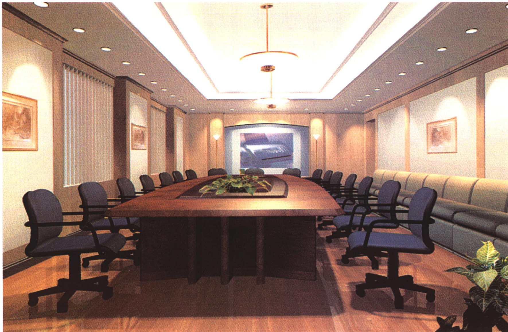
在小型会议室中常用上凸或下沉的顶棚造型来限定下部的会议区空间 彩图 23
