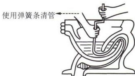
图 2-12 了解马桶构造
