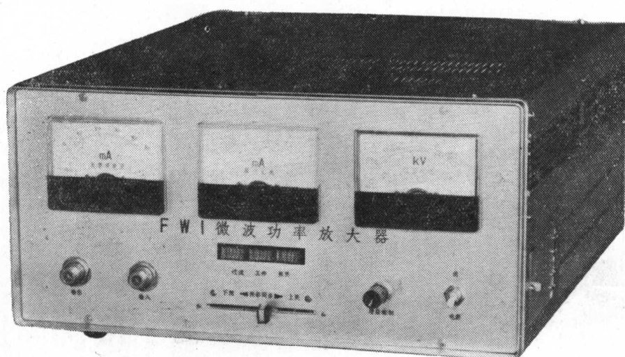
图 1-9 扁平式机箱 (铝合金型材折弯结构)
