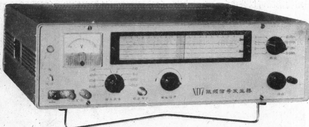
图1-4 扁平式机箱 (铝合金型材折弯结构)
