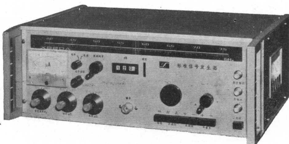
图 1-14 扁平式机箱 (铝压铸件与型材结构)
