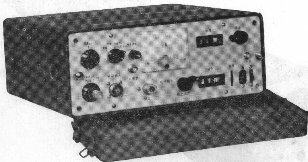
图 1-22 背色式机箱 (薄板结构)
