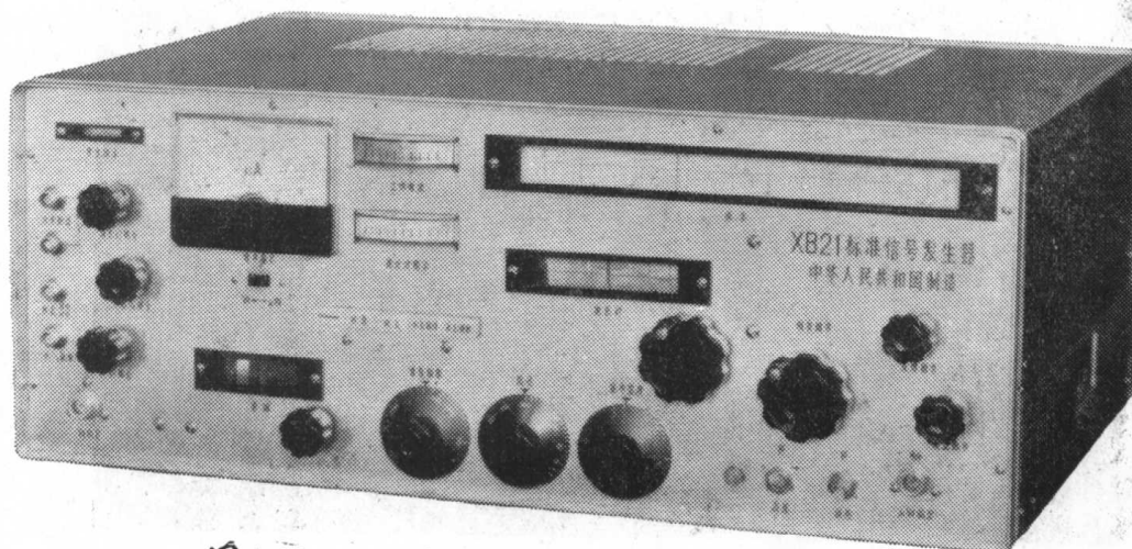
图1-7 扁平式机箱 (铝合金型材折弯结构)
