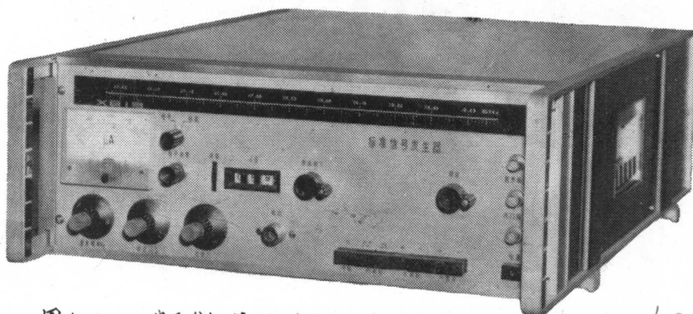
图1-6 扁平式机箱 (铝合金型材折弯结构)
