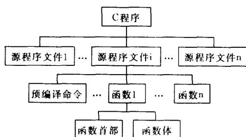
图 1.1 C 程序的结构
