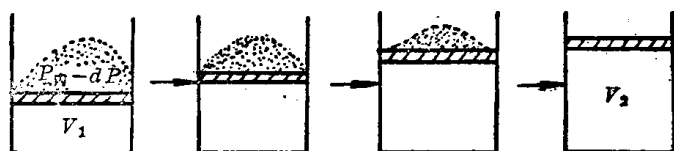
图 1-6 理想气体恒温可逆膨胀示意图
