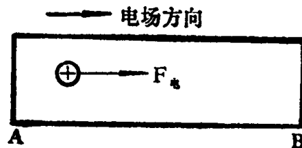
图1-4 导体中电流的形成
