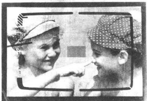
这个 35 毫米测距仪自动照相机的取景器上,用指针显示出被照
