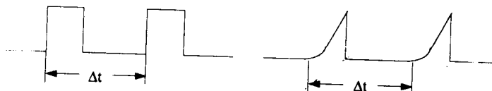
图 0-7 两种脉冲波形测距精度比较
