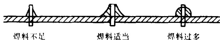
图 1-3 焊锡量适量与否示意图
