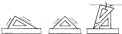
图 1-5 画 30^\circ 、 45^\circ 、 60^\circ 、 15^\circ 、 75^\circ 角
