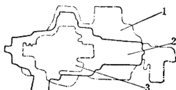
图 0-12 不同转速时锅炉给水泵 体积比较示意图
