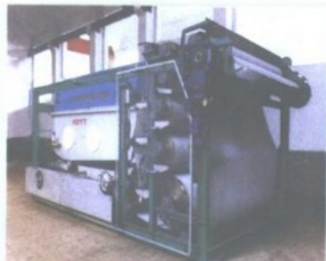
HDYT系列转筒浓缩脱水一体化装置 —引进欧洲先进技术的污泥脱水设备
