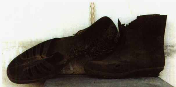
彩图 17 仓库储存塑料水鞋、凉鞋也遭白蚁蛀食破坏
